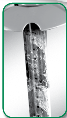
de la presencia de termitas en la estaca
